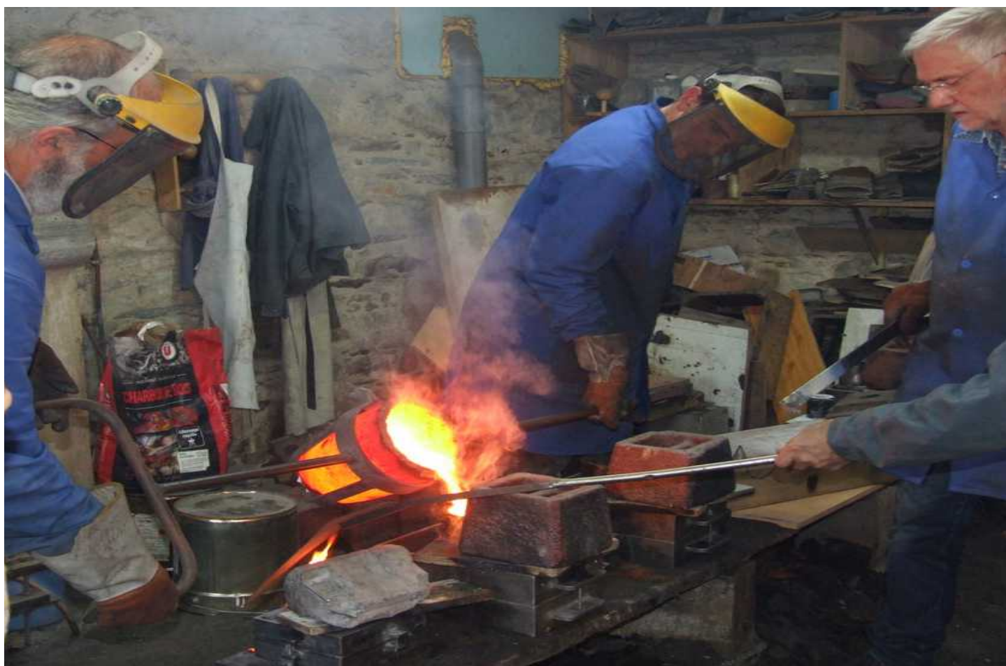
La coulée du métal en fusion lors d'une animation aux Forges de la Hunaudière.
