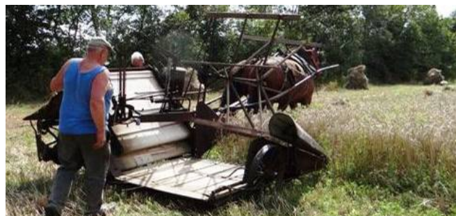
La moissonneuse-lieuse, appelée « la lieuse » lie elle-même les gerbes, ce qui permet un gain de temps très important. Ci-dessus, elle est entraînée par une paire de bœufs normands conduits par Laurent Legal. Ci-dessous, la lieuse est tirée par une paire de chevaux de trait de René Turbot.
